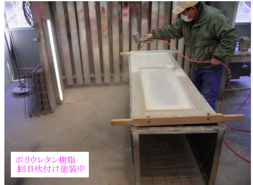
直営 青木様所有コーナーボード ポリウレタン樹脂 1回目吹付け 2010年2月20日
