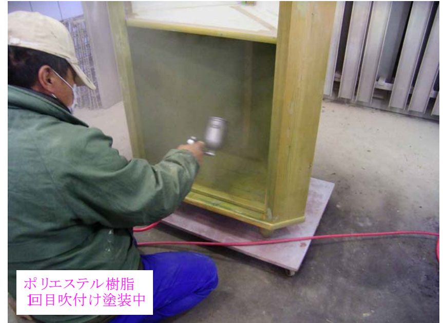
直営 青木様所有コーナーボード ポリエステル樹脂 1回目吹付け中 2010年2月19日
