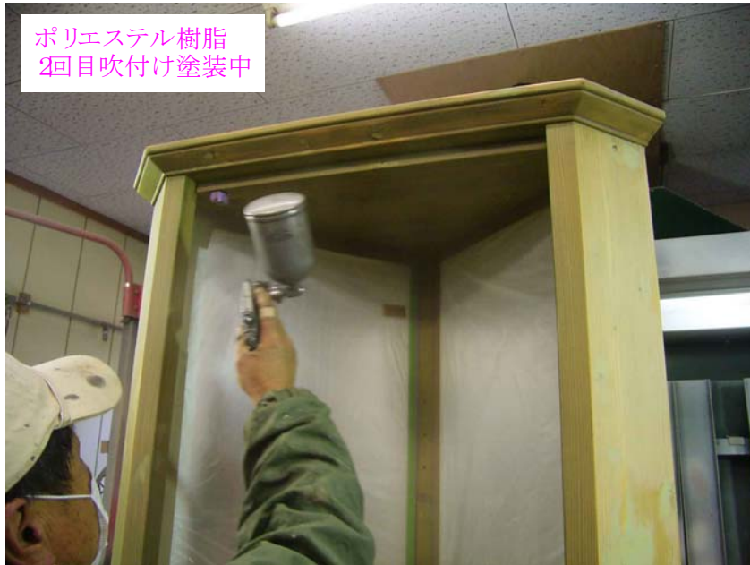
直営 青木様所有コーナーポット ポリエステル樹脂 2回目吹付け中 2010年2月19日
