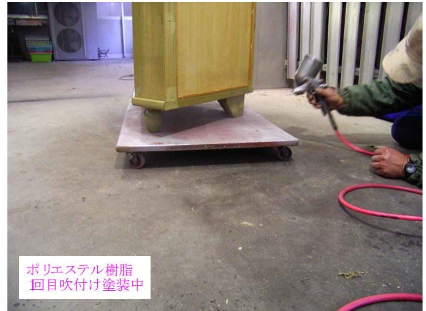
直営 青木様所有コーナーボード ポリエステル樹脂 1回目吹付け中 2010年2月19日
