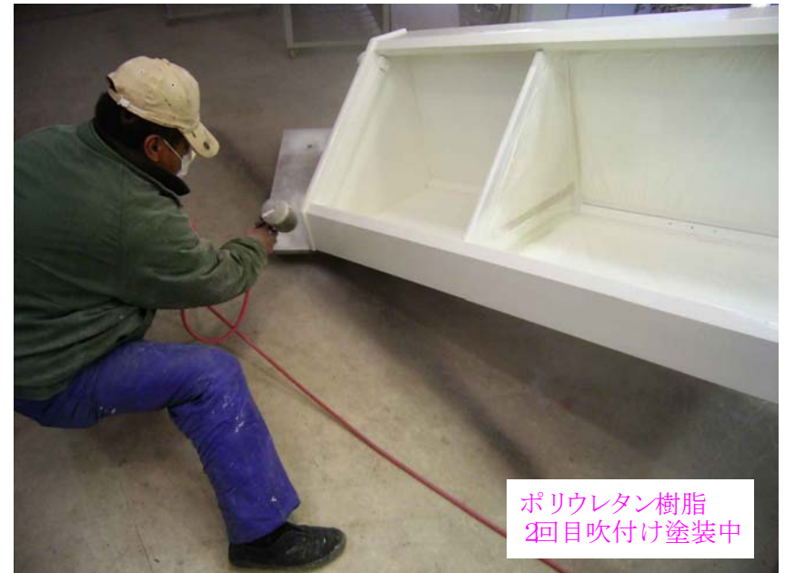
直営 青木様所有コーナーボード ポリウレタン樹脂 2回目吹付け中 2010年2月20日
