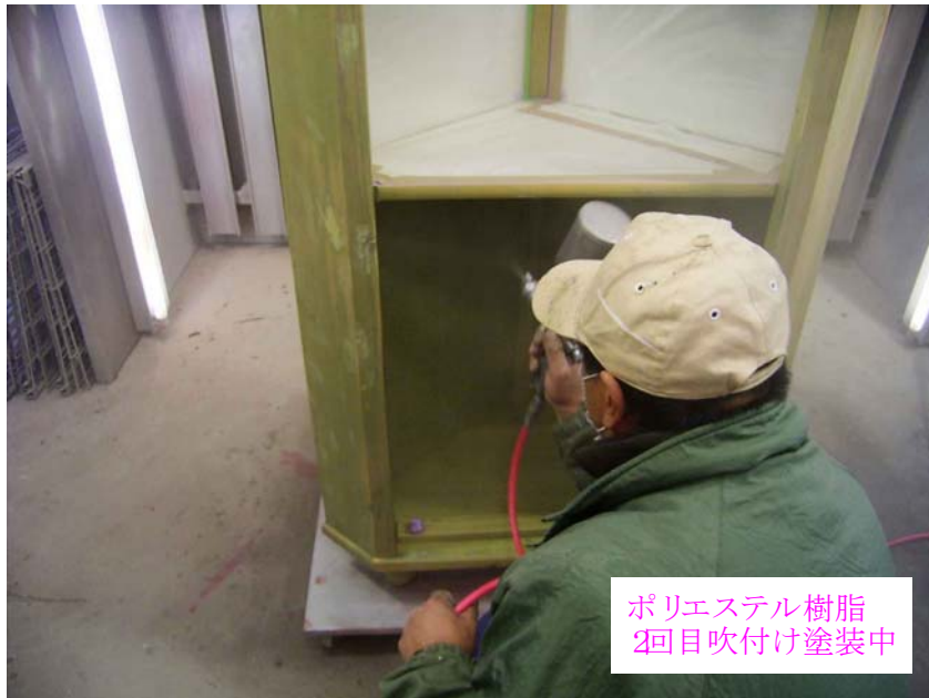
直営 青木様所有コーナーポット ポリエステル樹脂 2回目吹付け中 2010年2月19日
