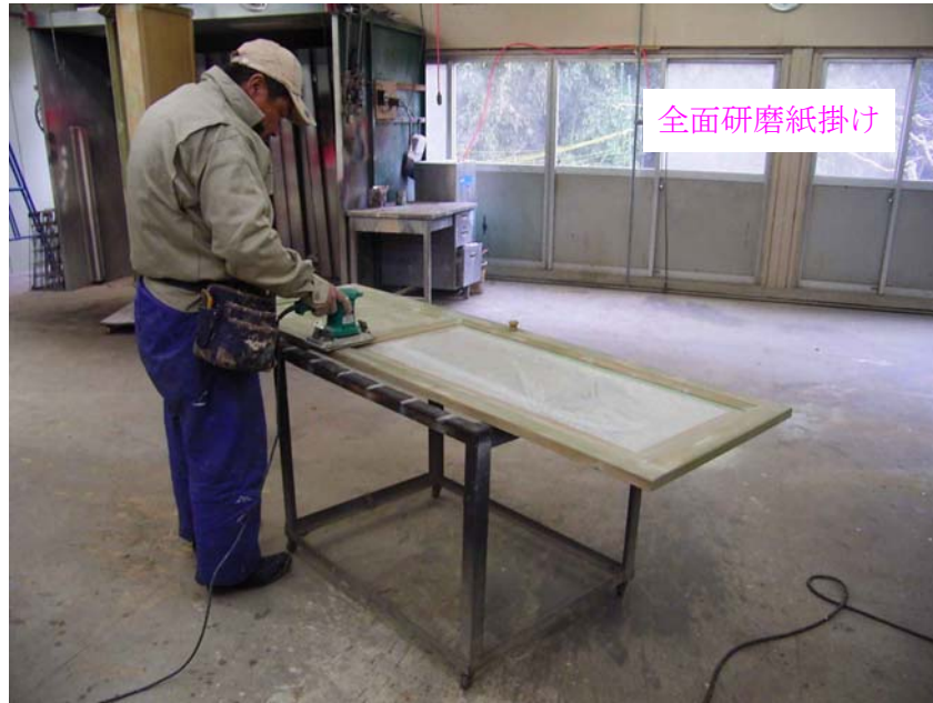
直営 青木様所有コーナート ホーリスル樹脂パテ中/後、ペーパー掛け 2010年2月16日
