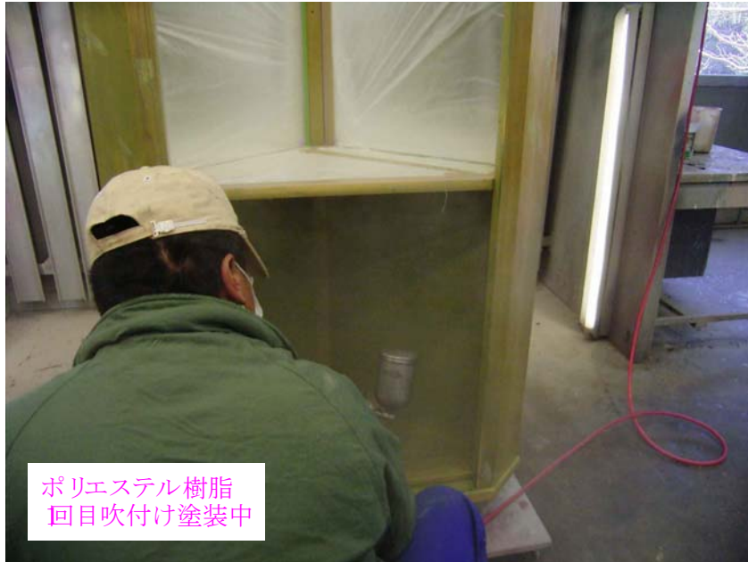
直営 青木様所有コーナーボード ポリエステル樹脂 1回目吹付け中 2010年2月19日
