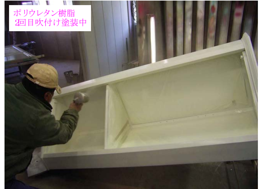
直営 青木様所有コーナーボード ポリウレタン樹脂 2回目吹付け中 2010年2月20日
