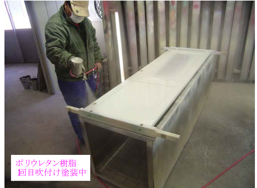
直営 青木様所有コーナーボード ポリウレタン樹脂 1回目吹付け中 2010年2月20日
