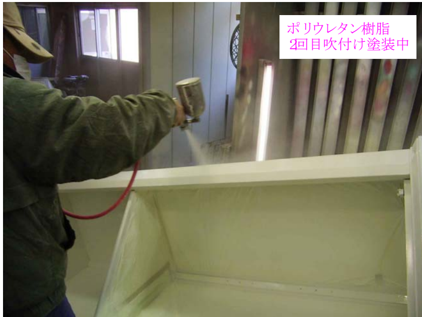
直営 青木様所有コーナーボード ポリウレタン樹脂 2回目吹付け中 2010年2月20日
