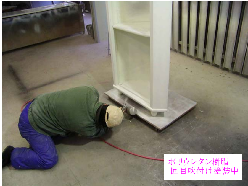
直営 青木様所有コーナーボード ポリウレタン樹脂 1回目吹付け 2010年2月20日
