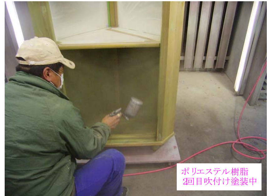
直営 青木様所有コーナーポット ポリエステル樹脂 2回目吹付け中 2010年2月19日
