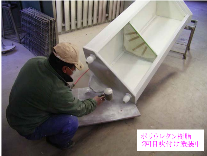
直営 青木様所有コーナーボード ポリウレタン樹脂 2回目吹付け中 2010年2月20日
