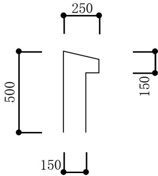
$$\begin{aligned} W1 &= 24 \times 0.15 \times (0.50 + 0.10) && \dots \text{CON} \\ &+ 23 \times 0.02 \times 0.50 && \dots \text{増打} \\ &+ 20 \times 0.025 \times 0.50 && \dots \text{タイル貼り} \\ &+ 0.20 \times 0.35 && \dots \text{防水立上} \\ &= 2.8 \text{ kN/m} \end{aligned}$$
